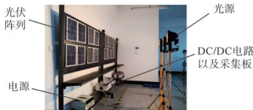
图 10 光伏系统实验平台
