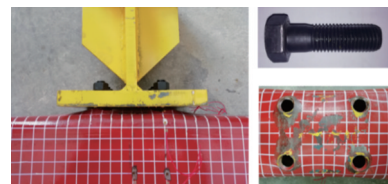
图 6 试件 S20-7-30 管壁屈服
