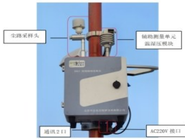
图1 DPCX型视程障碍现象安装完成示意图
