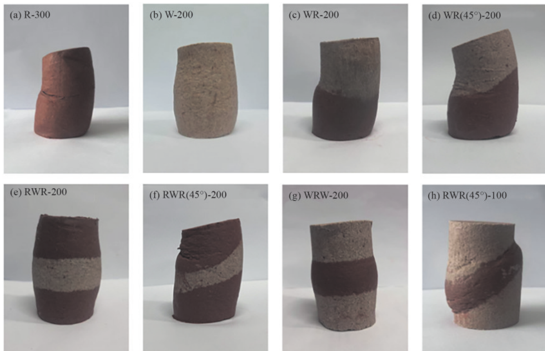
图 5 不同层理试样的剪切破坏示意
