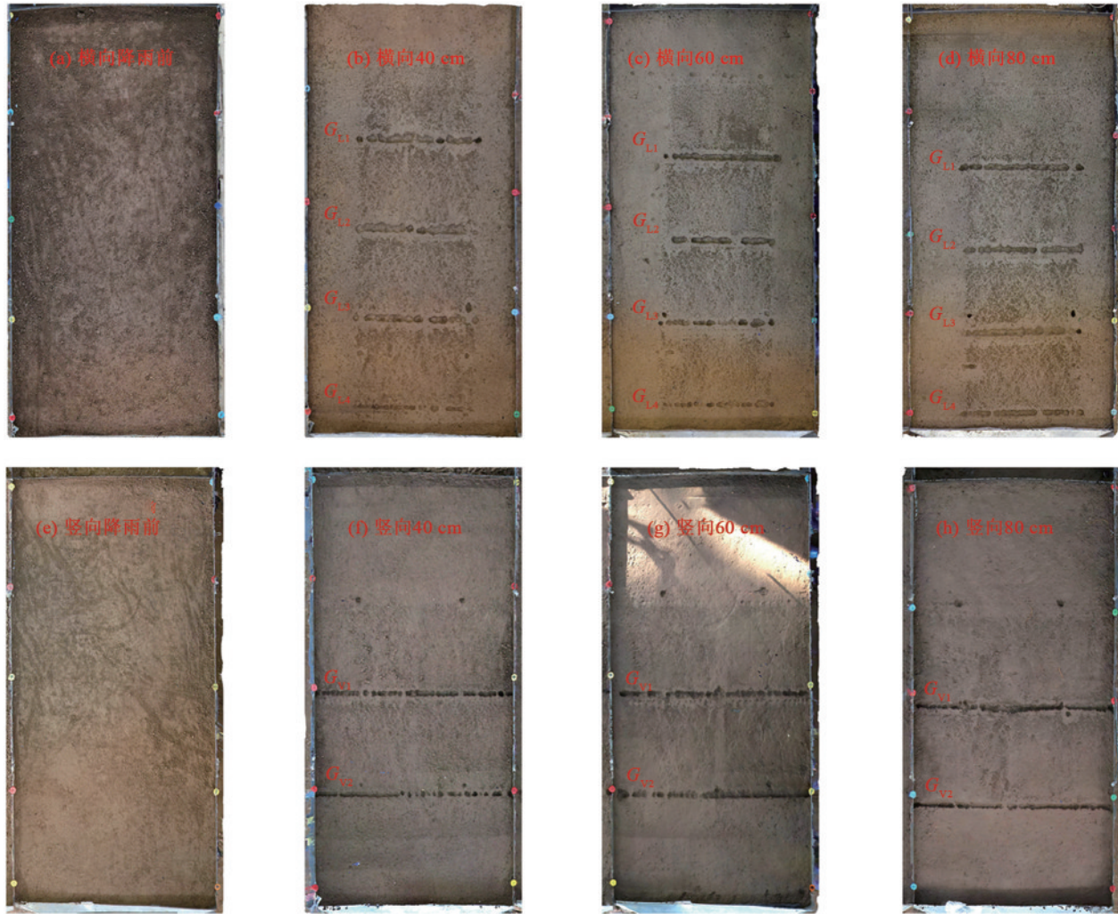
注:图中倾角均为 40°;G 1.1 为横向排列的第 1 条侵蚀沟;G 1.2 为横向排列的第 2 条侵蚀沟;G 1.3 为横向排列的第 3 条侵蚀沟;G 1.4 为横向排列的第 4 条侵蚀沟;G v1 为竖向排列的第 1 条侵蚀沟;G v2 为竖向排列的第 2 条侵蚀沟。
