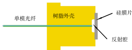
图 4 法珀腔传感头结构示意图
