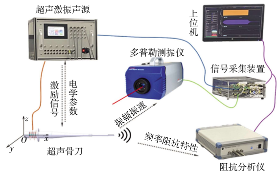
图 8 超声骨刀振动测试平台
