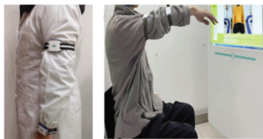
图3 低成本的可穿戴系统用于收集上肢运动数据并指导患者训练 [27]
