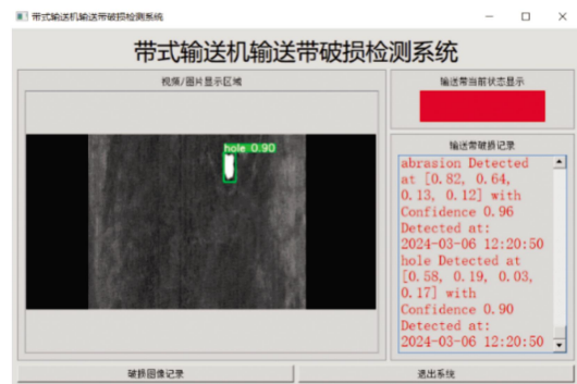
图 13 带式输送机输送带破损系统功能测试
