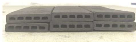
图 2 多通道导电炭膜实物
