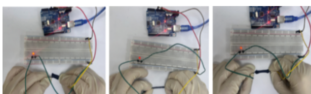
(c) PHP15%水凝胶在初始、拉伸、扭转状态下的导电性
