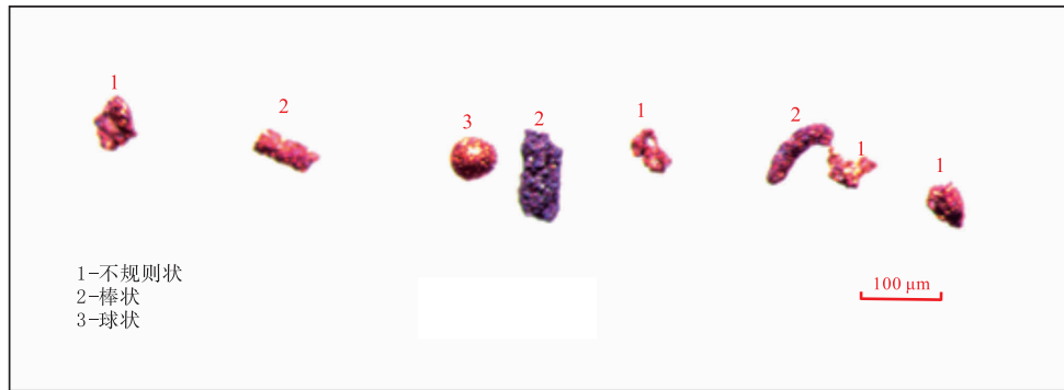
图 6 体视显微镜下南海台西南盆地 F 站位黄铁矿颗粒形貌图
