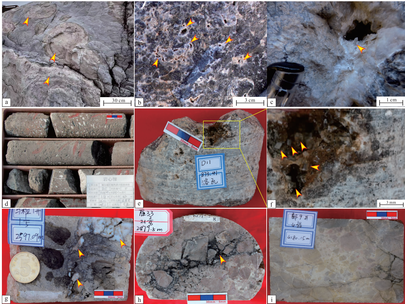
a—丘状叠层石白云岩，具有叠层结构的部分直接接触岩浆被大理岩化（见箭头），围岩部分仍是白云岩，雾迷山组，白石山剖面；b—深灰色块状泥晶白云岩发育溶孔，溶孔被白色白云石晶体充填一半充填（见箭头），雾迷山组，易县剖面；c—灰色白云岩被热液溶蚀的孔洞，洞壁上可见硅质胶结物和洁净石英晶体（见箭头），雾迷山组，蓟县剖面；d—玄武岩，侵入于雾迷山组中，D13井，雾迷山组，1501.43 m，岩心；e—灰色泥晶白云岩，溶孔中可见生长的白云石晶体（见箭头），D11井，雾迷山组，873.41 m，岩心；f—图 4-e 的局部放大；g—灰色粉晶白云岩，发育硅质发育白色硅质团块（见箭头），马检 1 井，雾迷山组，2597.09 m，岩心；h—角砾白云岩，白云岩角砾被蚀变为暗红色，角砾间充填黑色沥青质（见箭头），雁 33 井，雾迷山组，2879.5 m，岩心；i—角砾白云岩，白云岩角砾被蚀变为黄色—深红色，郑 9 井，雾迷山组，4180.15 m，岩心
