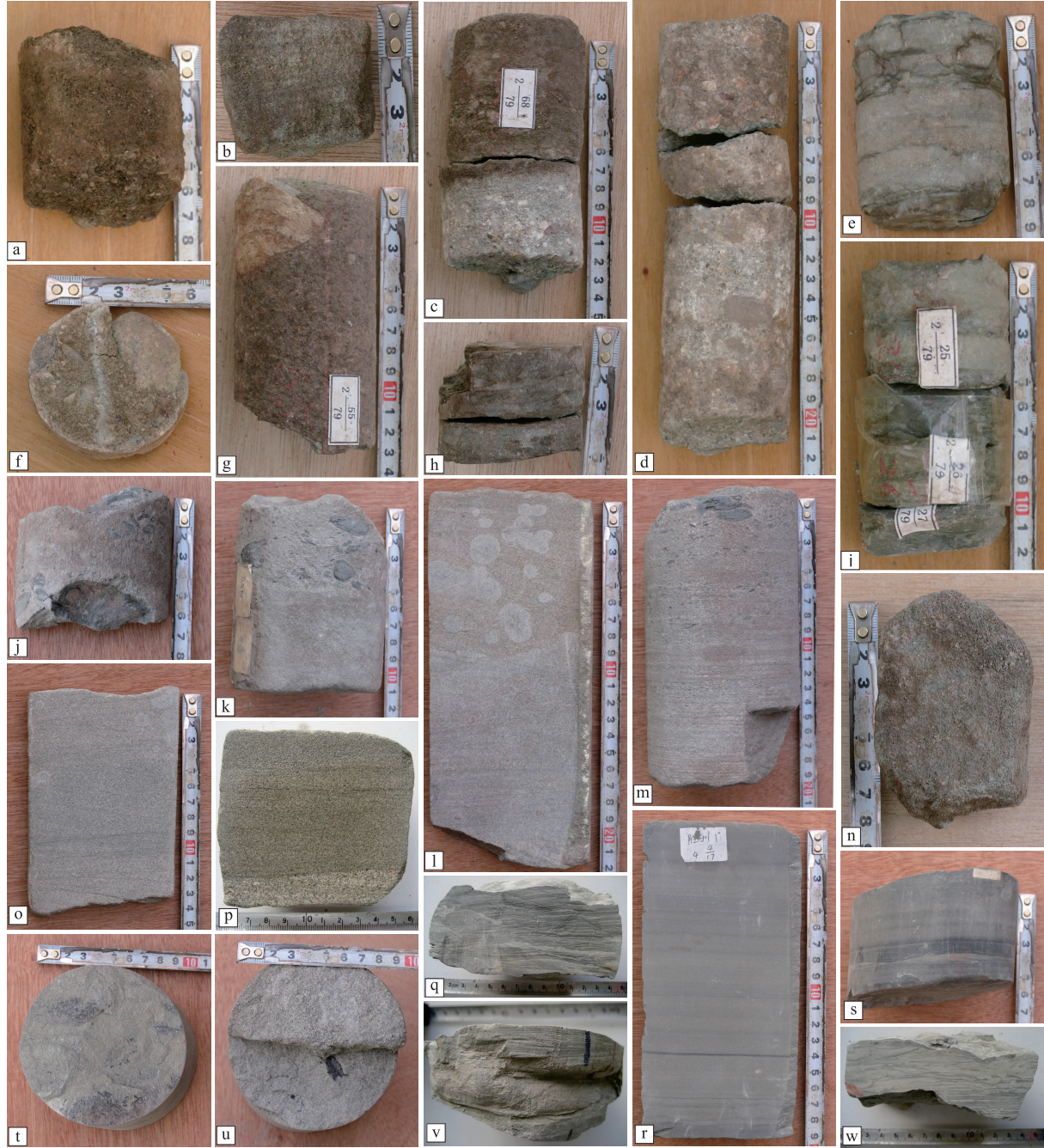
a—沙南 1 井, 油浸含砾粗砂岩, 6100.2 m; b—沙南 1 井, 6106.9 m, 中细砂岩, 板状交错层理; c—沙南 1 井, 油浸含砾砂岩, 6106.6 m; d—沙南 1 井, 砾岩, 砾石向上变小, 6105.4 m; e—沙南 1 井, 6102.6 m, 细砂岩夹薄层泥岩; f—沙南 1 井, 油浸砂砾岩, 6100.2 m; g—沙南 1 井, 灰绿色中粗粒砂岩, 6104.8 m; h—沙南 1 井, 6106.7 m, 泥质粉砂岩, 层面含云母片; i—沙南 1 井, 灰绿色泥岩夹粉砂岩条带, 6102.3 m; j—胜利 1 井, 4659.02 m, 含泥砾中粗粒岩屑砂岩; k—胜利 1 井, 4659.07 m, 含泥砾中粗粒砂岩, 冲刷面; l—胜利 1 井, 4855.47 m, 中粗粒岩屑砂岩, 楔状交错层理, 钙质团块; m—胜利 1 井, 4663.77 m, 含泥砾砂岩, 反粒序; n—沙南 1 井, 6108.1 m, 中粗砂岩, 平行层理; o—胜利 1 井, 4855.82 m, 中粗粒岩屑砂岩, 楔状交错层理; p—满西 1 井, 3482.8 m, 中粗粒岩屑砂岩, 正粒序; q—满西 1 井, 3588 m, 粉砂质泥岩, 水平层理; r—胜利 1 井, 4909.87 m, 泥质粉砂岩, 水平层理; s—胜利 1 井, 4910.27 m, 粉砂质泥岩, 透镜状层理; t—胜利 1 井, 4909.17 m, 粉砂岩, 层面见植物碎片; u—胜利 1 井, 4660.57 m, 砂岩层面见芦木化石; v—满西 1 井, 3591 m, 泥质粉砂岩, 水平层理; w—满西 1 井, 3588 m, 泥质粉砂岩, 层间滑动构造
