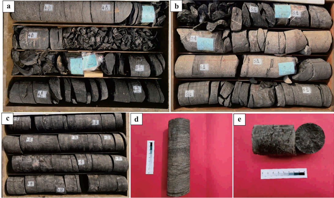
a—山西组含碳泥页岩、灰色砂质泥页岩；b—太原组灰色细砂岩；c—太原组灰黑色泥页岩； d—山西组典型泥岩—粉砂岩；e—太原组典型泥页岩
