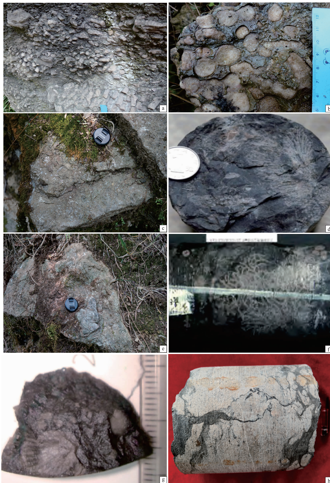
a—华蓥山石牛栏组珊瑚礁灰岩；b—华蓥山石牛栏组珊瑚横切面，虫管密集发育；c—宜宾兴文县石牛栏组生屑灰岩；d—降盛 2 井石牛栏组生屑灰岩（王海军等，2016），4001.76 m；e—宜宾兴文县石牛栏组生物礁灰岩；f—D1 井石牛栏组生物礁灰岩（白壮壮等，2023），1173 m；g—西门 1 井石牛栏组生物礁灰岩（王海军等，2016）；h—G18 井石牛栏组生屑灰岩，岩溶角砾及溶沟发育，3756.97 m
