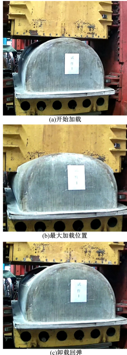
图3 柔性护舷足尺压缩试验
