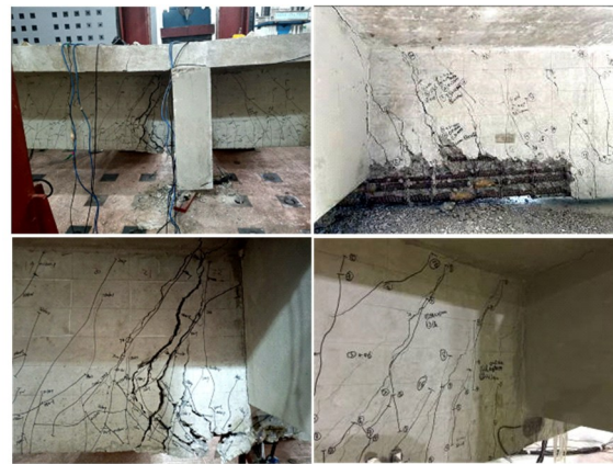
(a) 试验梁疲劳破坏裂缝情况
