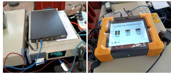
(a)UCAM-60B 静态数据采集仪 (b)HC-F800 混凝土裂缝缺陷综合测试仪
