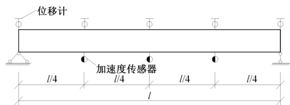
图 7 试验梁测点布置图
