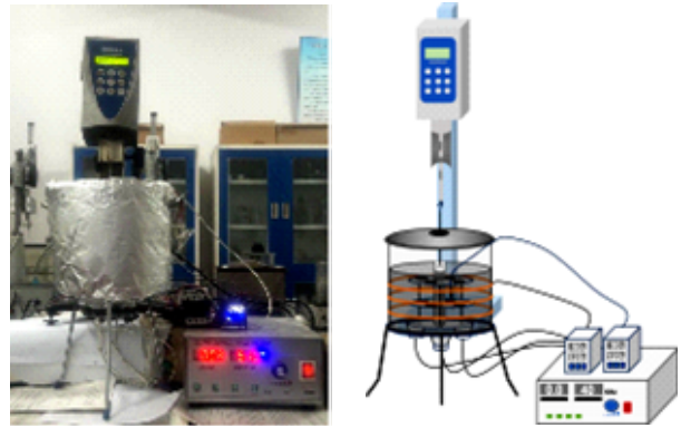
图 3 熔融沥青的实时黏度测试
