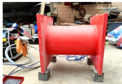
图 2 螺杆蠕变试验总体布置
