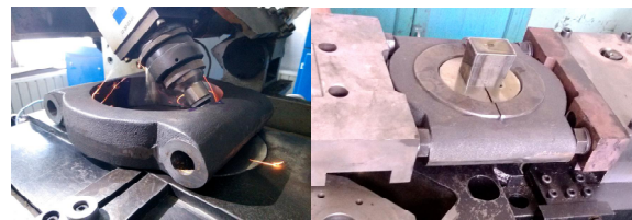
图 9 裂解设备及试件 Fig. 9 Fracture split specimen
