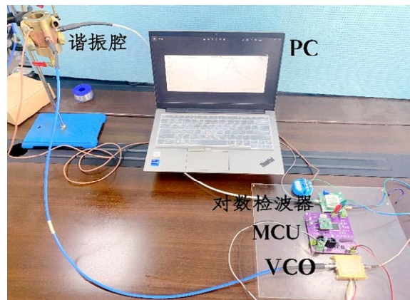
图 11 试验检测装置
