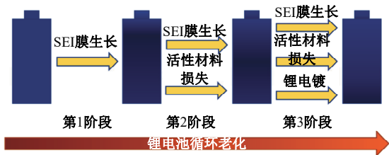
图 3 锂电池循环老化的 3 个阶段
