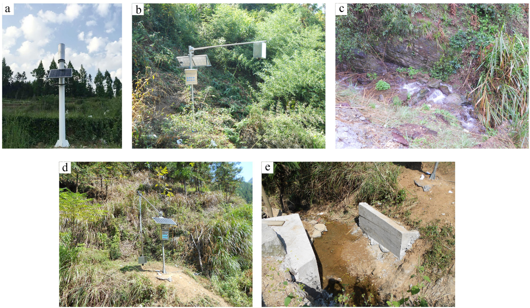
a. 雨量监测系统布置;b. 超声波泥水位监测系统;c. 沟道监测断面;d. 沟道流量监测系统;e. 沟道量水堰槽。
