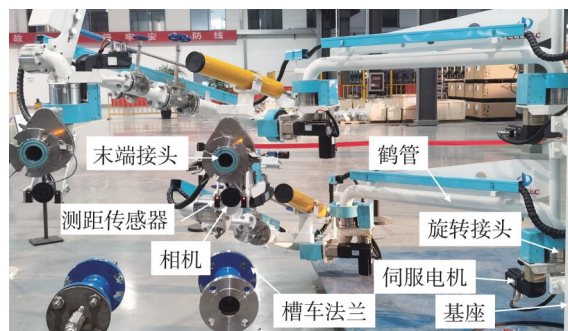
图 4 对接系统试验平台
