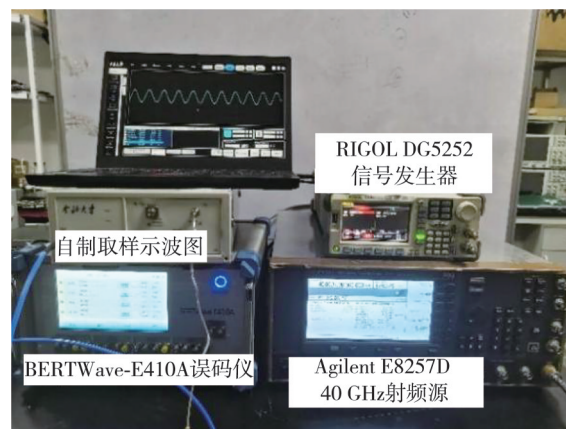
图4 硬件测试平台
