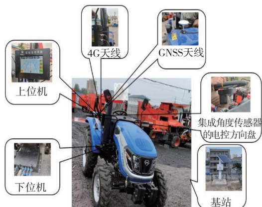
图3 系统安装示意图
