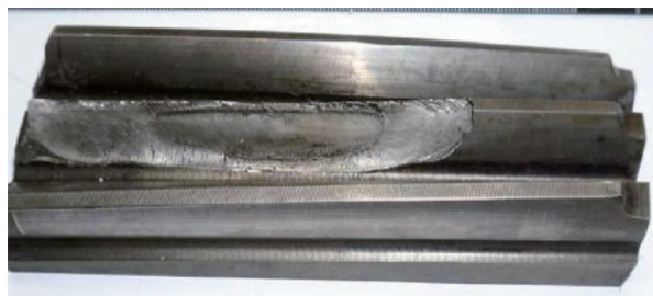
图 25 高速级小齿轮断齿宏观形貌
