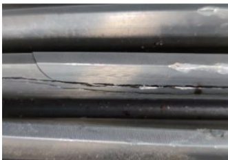
图 7 低速轴大齿齿面裂纹
