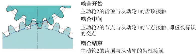
图 4 齿轮啮合的变化过程
