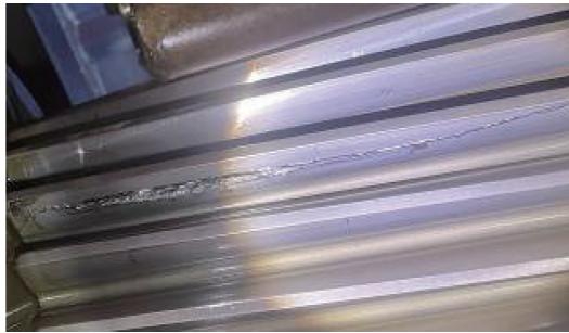
图 16 中间级小齿轮齿面裂纹
