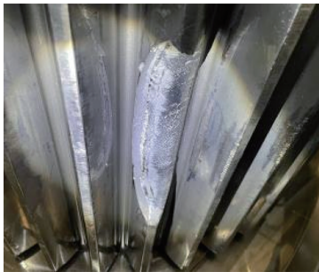
图36 行星轮断齿形貌
