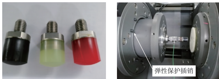
图5 碰撞冲击的橡胶缓冲垫及传感器安装图
