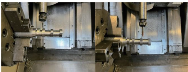
(a) 凸轮轴粗加工
