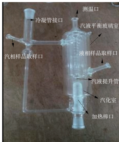
图 1 Rose 汽液平衡釜结构
