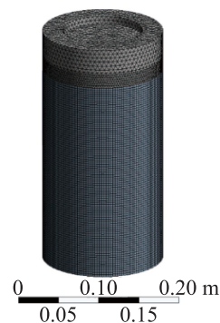
图3 电渣接续重熔有限元网格划分示意图
