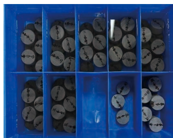
图1 试件浸泡实况
