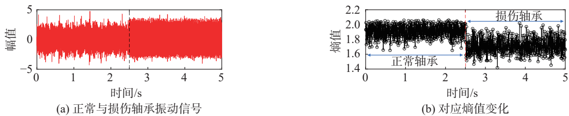
图1 正常与损伤轴承振动信号的熵值变化对比
