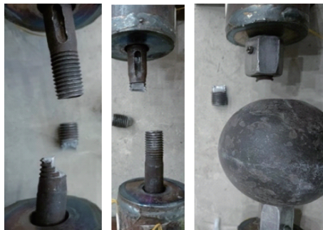
图8 螺栓球节点试验破坏现象
