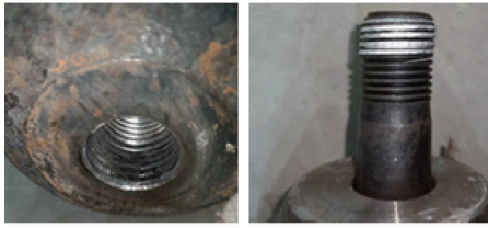
图10 螺栓球节点试验破坏现象(M27-4)
