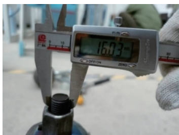
图4 高强度螺栓尺寸测量
