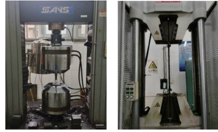
图4 钢材材性试验
