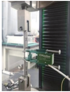
图5 材性试验装置
