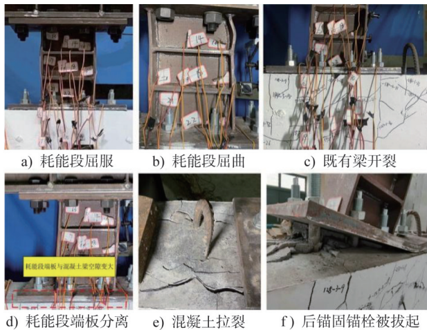
图6 试件 ECB-SL-1 破坏模式
