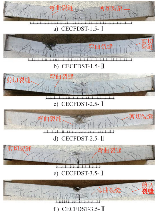
图5 受弯试件破坏模态
