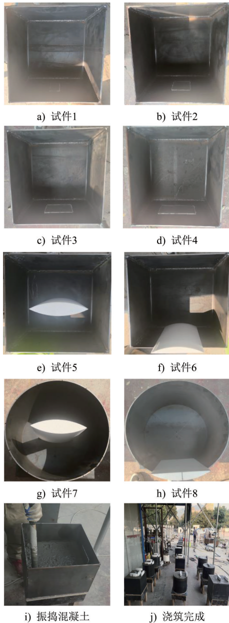
图2 缺陷粘贴后及混凝土浇筑示意
