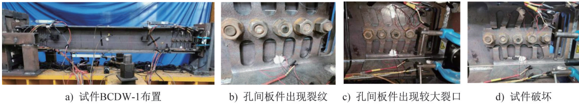
图7 试件BCDW-1试验现象
