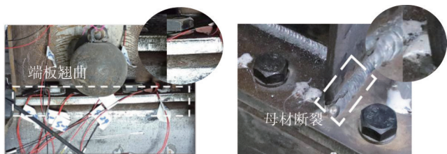
图5 试件 OEP1 破坏模式
