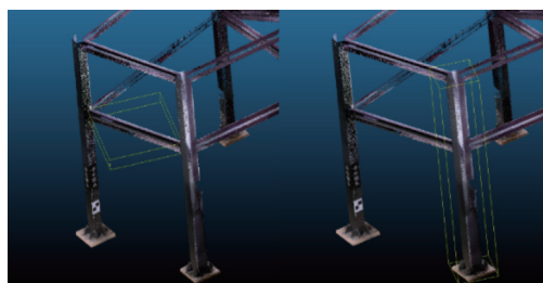
图9 梁柱点云聚类分割
