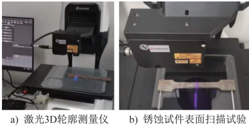
图3 锈蚀试件表面轮廓测量
