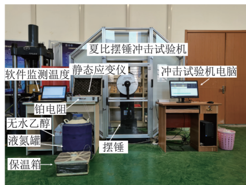
图 12 冲击试验现场
