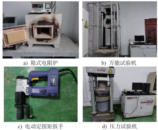
图2 试验加热设备及加载装置
