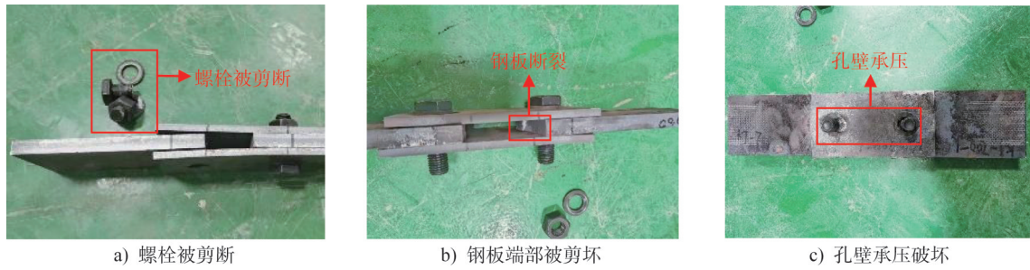
图5 试件破坏模式
