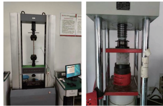
a) 金属拉伸试验 b) 混凝土立方体抗压试验
