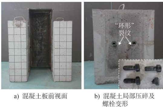
图7 试件ST-40-2破坏模式
