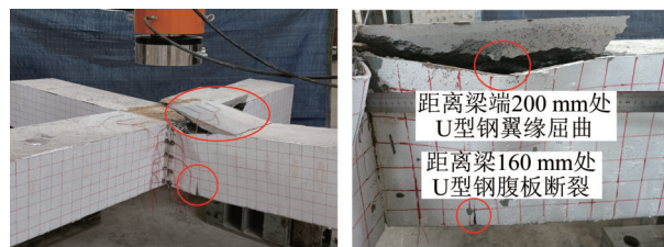
a) 钢腹板破坏(试件WLTR-32) b) 钢腹板破坏(试件WLTR-32)
