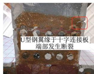
c) 钢翼缘断裂(试件WLTR-32)
