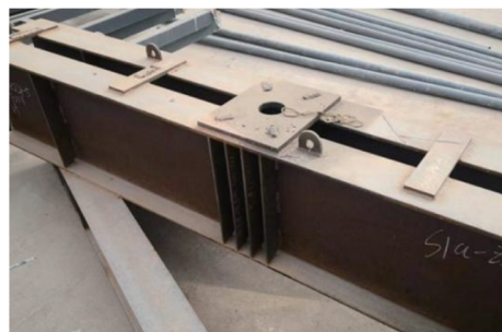
图 23 装配式提升梁照片
